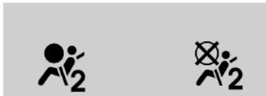
Los símbolos del indicador de estado del airbag del acompañante se encenderán durante algunos segundos como comprobación del sistema. Luego, después de varios segundos más, el indicador de estado se encenderá para informarle el estado del airbag frontal y el airbag para la rodilla del acompañante delantero.
