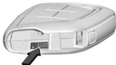
2. Separe las dos mitades de la llave remota usando el paletón de la llave mecánica insertada en la parte inferior central de la llave remota. No use la ranura para la llave.
