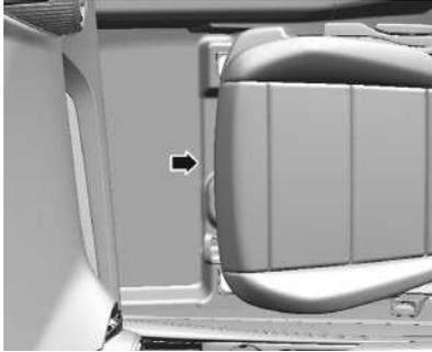
El vehículo tiene un lugar adecuado para montar el extintor de incendios, debajo del asiento delantero del acompañante y por debajo de la alfombra. El extintor de fuego y sus soportes se pueden adquirir e instalar en los concesionarios de Chevrolet.
