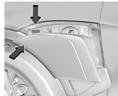
2. Presione la esquina superior izquierda de la tapa del puerto de carga y suéltela para abrirla.
