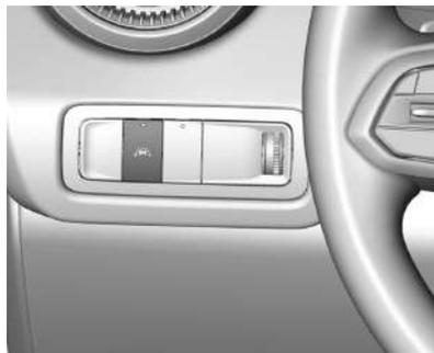
Para activar o desactivar el LKA, pulse
