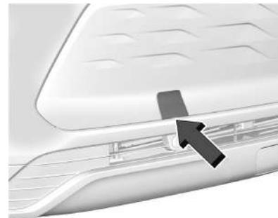
1. Abra cuidadosamente la tapa de la fascia utilizando la ranura pequeña que oculta el zócalo de la argolla de remolque.
