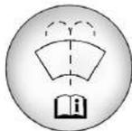
Abra el tapón que tiene el símbolo del lavaparabrisas. Agregue líquido del lavaparabrisas hasta que se llene el tanque. Vea la ubicación del depósito en *Vista general del compartimento debajo del capó* ⇨ 247.
