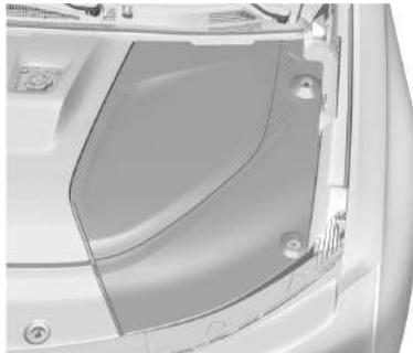
3. El depósito del refrigerante está debajo de las cubiertas de acceso debajo del capó. Para quitarlo, consulte *Cubiertas de acceso debajo del capó* ⇨ 245.
