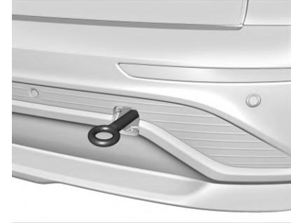
2. Coloque la argolla de remolque en el zócalo y gírela hasta que quede completamente apretada. Cuando se desmonte la argolla de remolque, vuelva a colocar la tapa con la muesca en la posición original.
