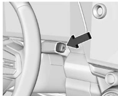
**P** : Esta posición bloquea las ruedas de tracción. Use P (Estacionamiento) cuando arranque el vehículo, para asegurarse de que el mismo no se mueva.
