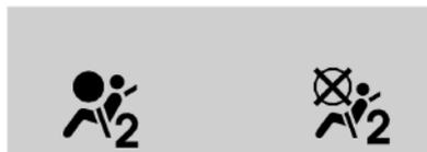
Cuando el vehículo arranca, el indicador de estado del airbag del pasajero iluminará los símbolos de on (activado) y off (desactivado) varios segundos, como comprobación del sistema. Luego, después de varios segundos más, el indicador de estado encenderá el símbolo de activado o desactivado para
