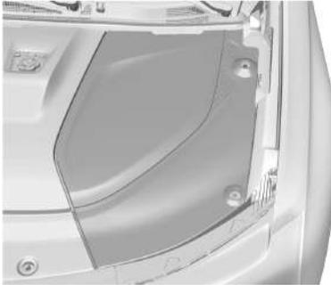
5. El terminal positivo (+) de la batería y el punto de puesta a masa negativo (-) se encuentran debajo de las cubiertas de acceso debajo del capó. Para quitarlo, consulte *Cubiertas de acceso debajo del capó* ⇨ 245.
