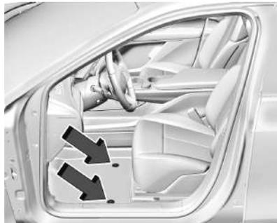
1. Tire hacia arriba de la parte trasera del cubrealfombras para desbloquear los retenes y removerlo.
